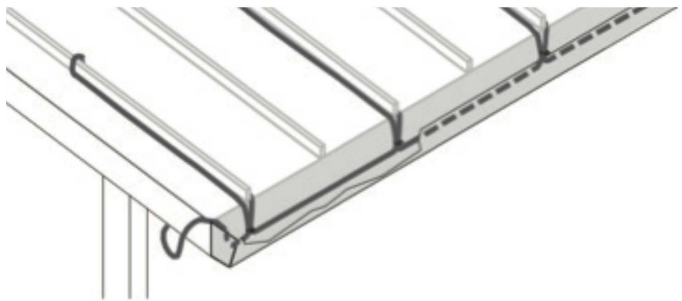
Déglaçage de toit et gouttière : toit en métal à joints debout
